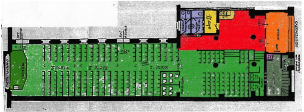
Abbildung 1: Bestuhlungsplan des Deutschen Lichtspielhauses in der Berliner Friedrichstraße (Quelle: Schliepmann: Lichtspieltheater. Einfärbung durch den Autor: Kassenfoyer orange; Kassenraum lila; Toiletten blau; Büfett ocker; Garderobe gelb; Kinofoyer rot; Zuschauersaal hellgrün; Bühne dunkelgrün; Vorführraum grau).
